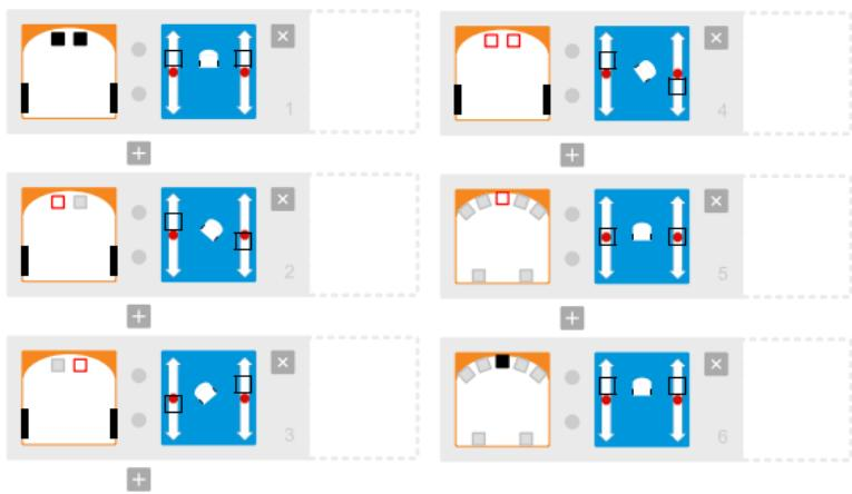
Les quatre premières lignes utilisent les capteurs de sol infrarouge pour permettre à Thymio de suivre la piste.
